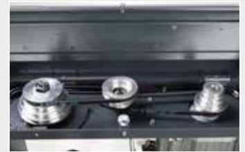
Abb. Riemenantrieb DQ 22. Bei DQ 14/18 zwei Riemenscheiben
